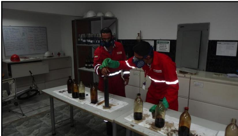
**Anexo 4. Determinación de la gravedad API por Hidrómetro.**
